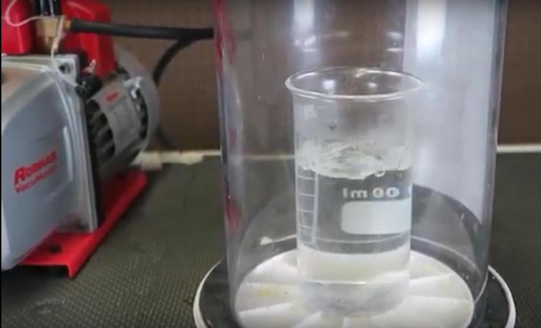
Si on enlève l'air = la pression de l'atmosphère, l'eau liquide se met instantanément à bouillir, elle n'est alors plus stable.
